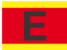
Sinalização de extintor em coluna
