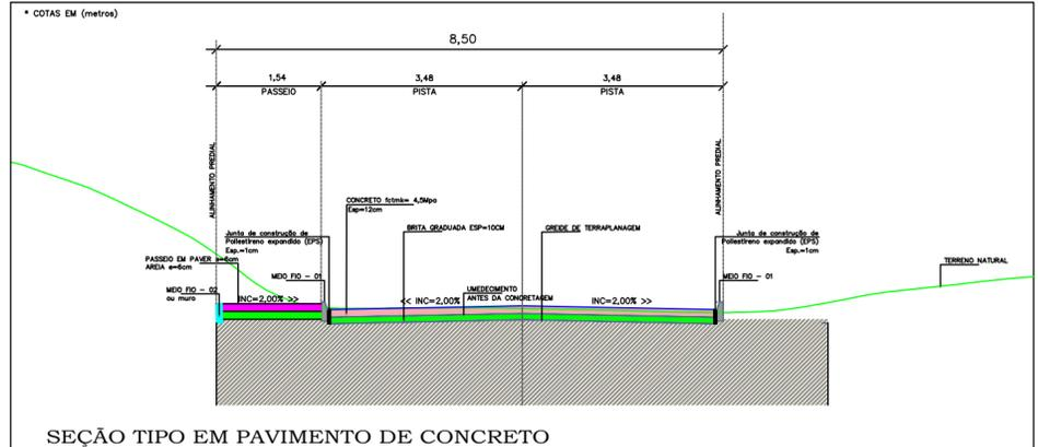
SEÇÃO TIPO EM PAVIMENTO DE CONCRETO
